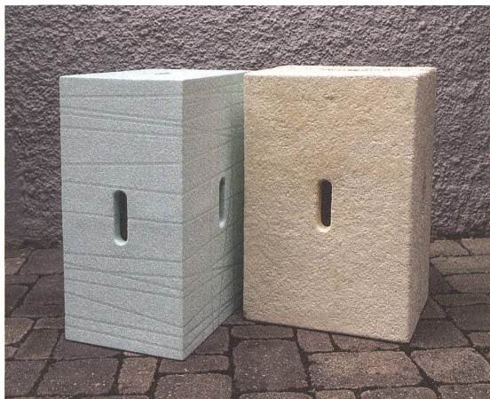
Einmal mit und einmal ohne Pilz: der Hocker «Xbrick» aus Polypropylen (links) und aus Myzelstoff.
