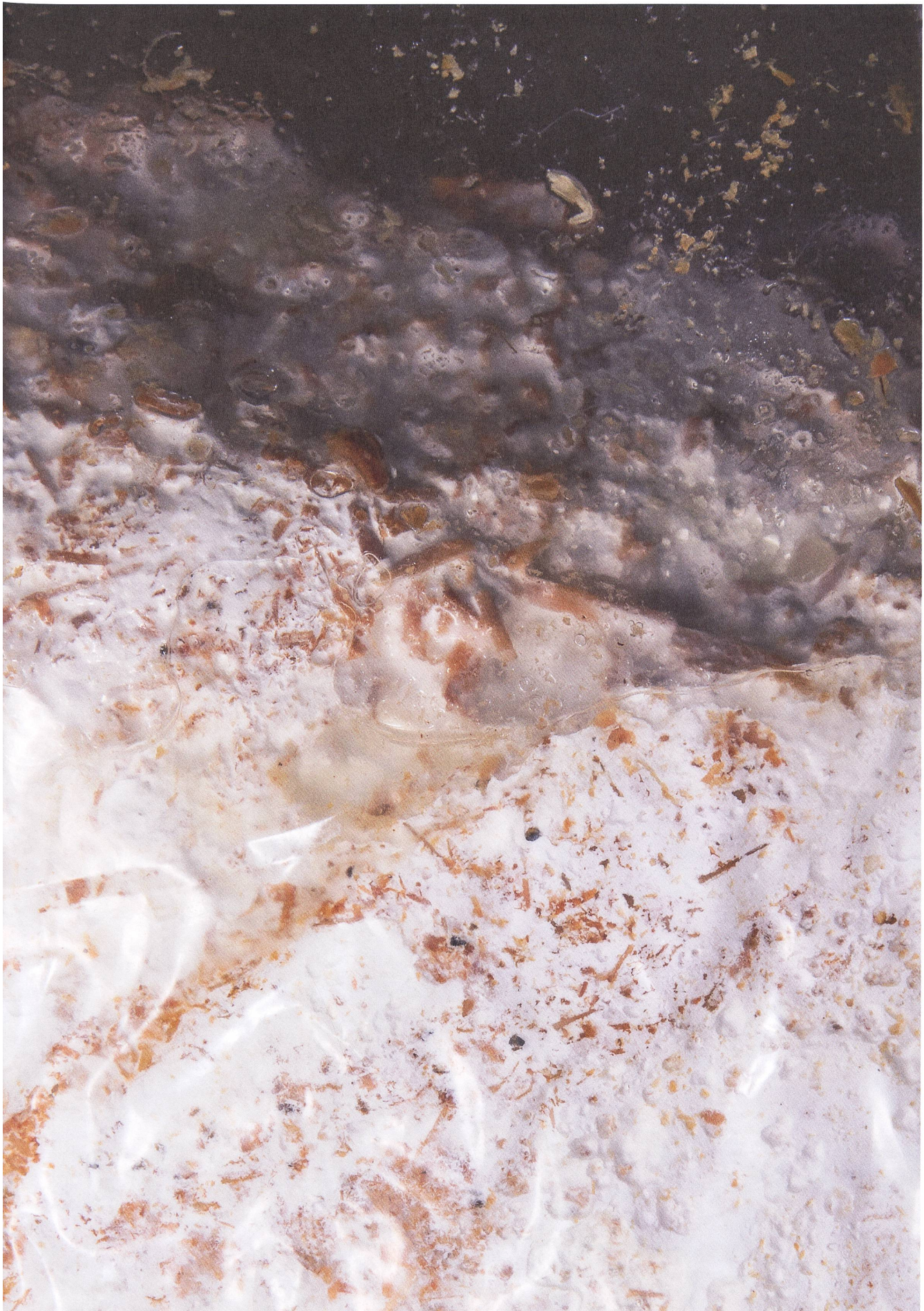
Magische Mischung: Das Myzel ernährt sich von organischem Abfallmaterial wie Spreu und verbindet sich mit ihm zu einer festen Masse.
