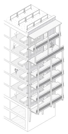
$Konstruktions axonometrie\ Laubengang.$
