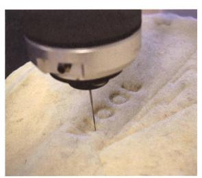
Automatisierter Filzprozess, umgesetzt von einem Roboterarm.
