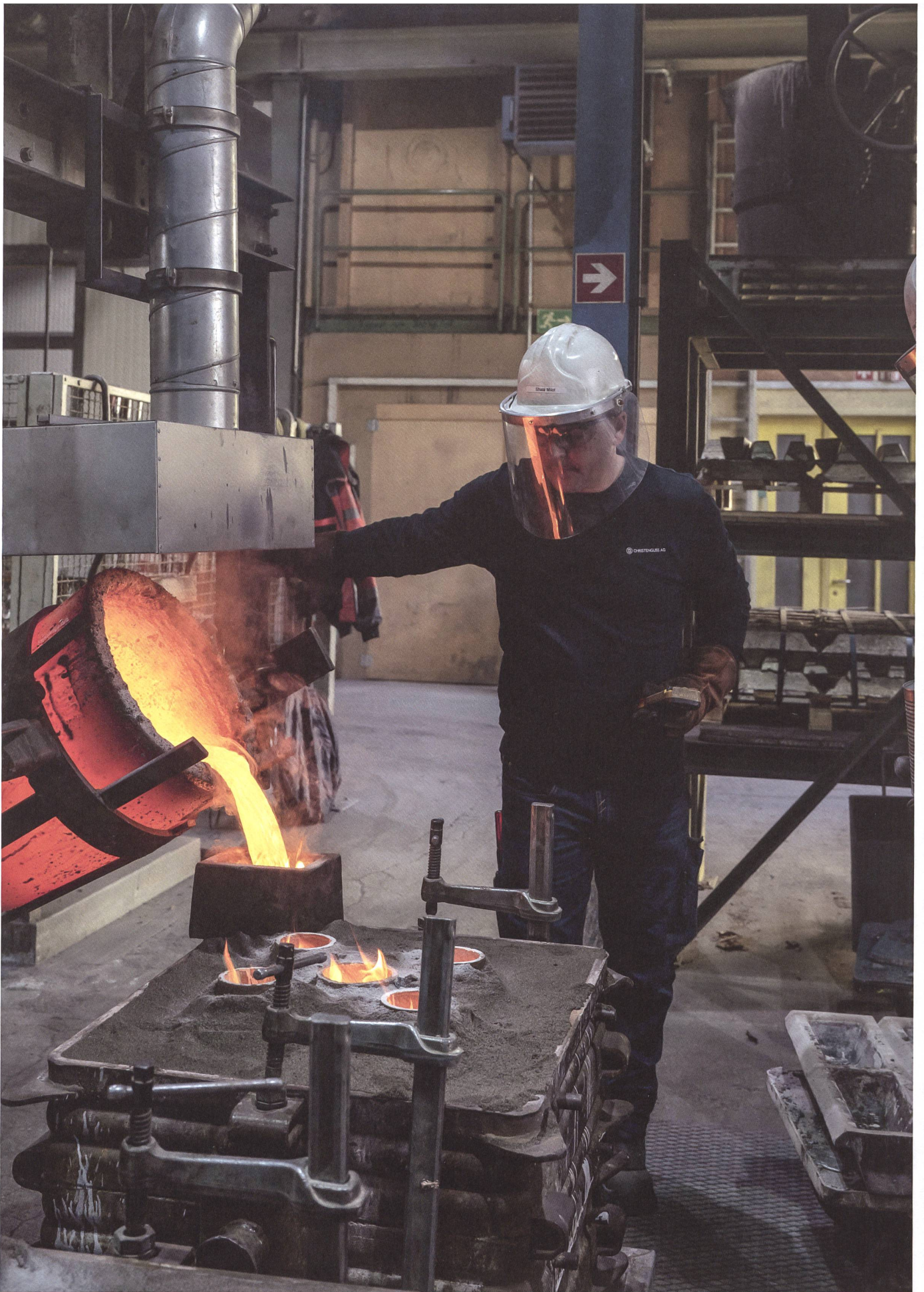
Flüssiges Aluminium fließt in die mit dem hauseigenen 3-D-Drucker hergestellten Sandgussformen.
