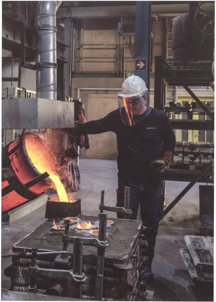
${\it Fl\"{u}ssiges Aluminium fliesst in die mit dem hauseigenen 3-D-Drucker hergestellten Sandgussformen.}$
