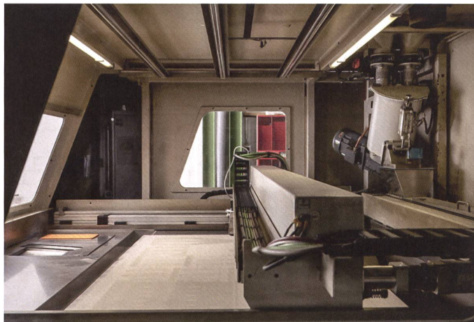
Der 3-D-Drucker kann in kurzer Zeit komplexe Gussformen herstellen.
