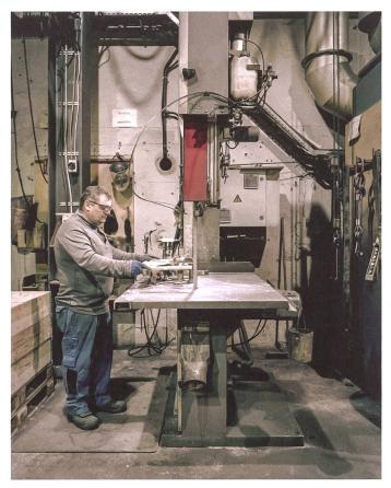
Ein Arbeiter trennt die Giessstruktur vom eigentlichen Gussteil ab, das danach abgeschliffen wird.
