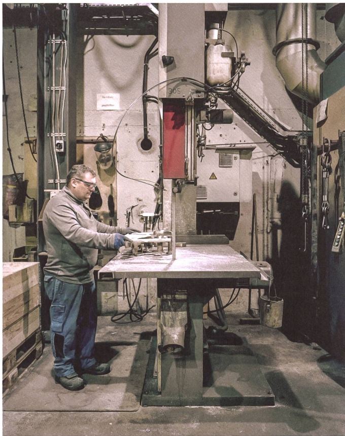
Ein Arbeiter trennt die Giesstruktur vom eigentlichen Gussteil ab, das danach abgeschliffen wird.
