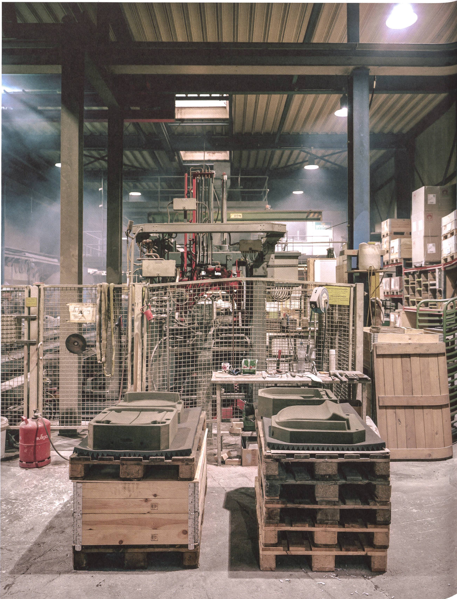
Die Gussformen aus gefestigtem Sand entstehen in einem 3-D-Druckverfahren, das Christenguss entwickelt hat. Nach dem Aushärten der Gussteile werden die Formen zertrümmert.
