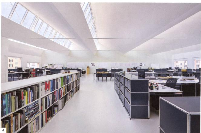
→ innenliegenden Storen verdunkelt werden. Nicht zu hell und nicht zu dunkel, das garantiert eine gute Arbeitsatmosphäre. Die Dreifachverglasung reduziert den Wärmeverlust. Die nach Süden ausgerichteten Flächen der Sheddach-Konstruktion sind fast vollflächig mit Photovoltaikelementen belegt.
