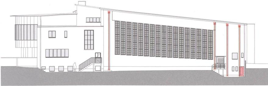
Die Anordnung der Mauerschlitze in der Ostfassade zeigt die Zurückhaltung des Eingriffs. | *La disposition des fentes dans la façade Est révèle une intervention discrète.*
