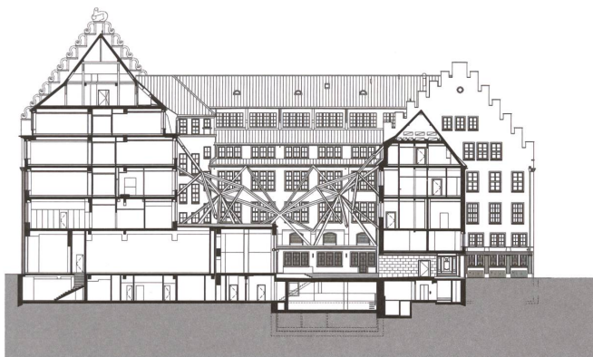
Der Erdbebenschutz wird im Innenhof sichtbar. | La protection parasismique est visible dans la cour intérieure.
