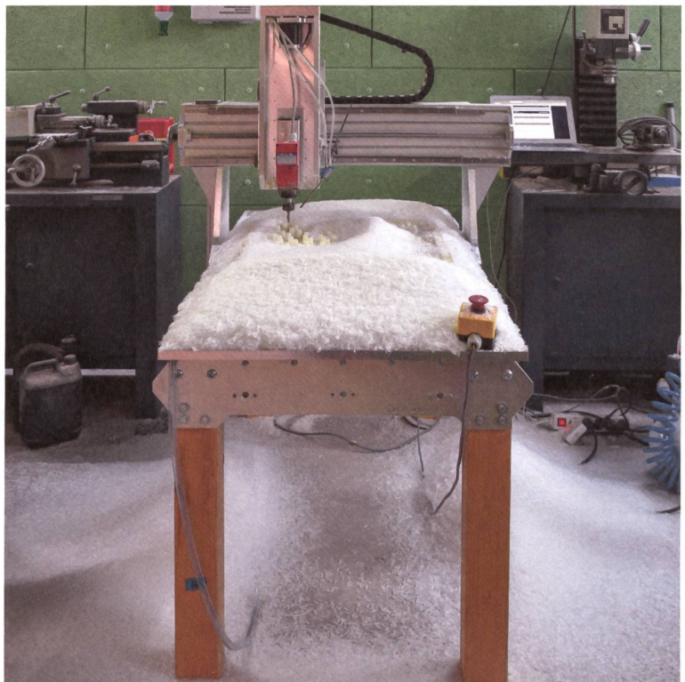
Die Gussformen entwickelten die Designer aus Wachs, das gefräst und eingeschmolzen werden kann.
