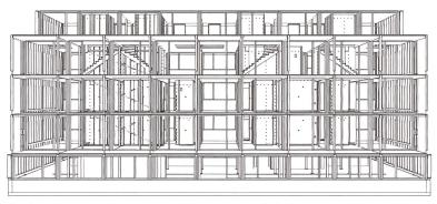
Der strenge Raumraster aus Holz mit einem Fuss aus Beton und Aussteifungskreuzen aus Stahl.
