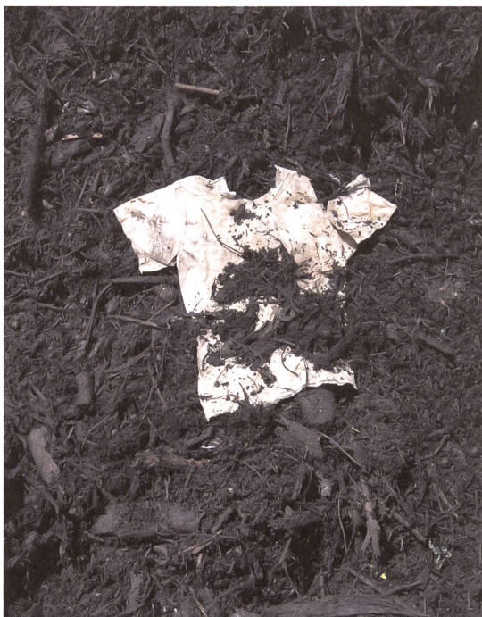
Benjamin Bichsel testete den Materialabbau in einer industriellen Kompostieranlage und konnte aufzeigen, dass ein natürlicher Zerfall der Kleidung möglich ist. Foto: Benjamin Bichsel
