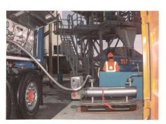
Das flüssige CO₂ wird in Gasform umgewandelt, bevor es in den Container mit dem Betonbruch gelangt.
