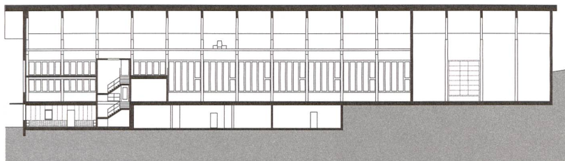
Längsschnitt. Unter den Werkräumen, im Hanggeschoss, befinden sich Büroräume und die Einstellhalle.
