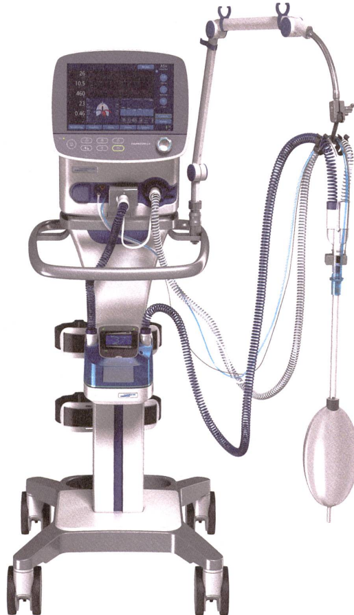
Das stationäre Modell C3 steuert die Beatmung automatisch basierend auf Zielwerten für Ventilation und Oxygenierung.
