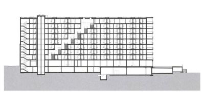
Längsschnitt durch Haus B mit Kaskadentreppe.
