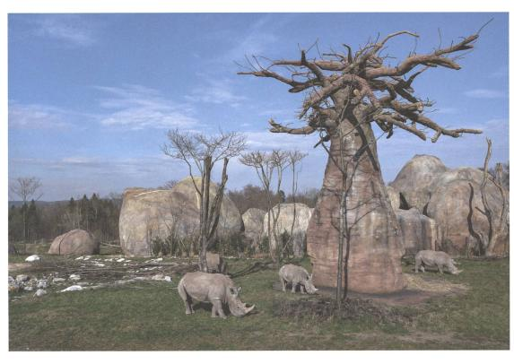
Dieser gegen zwanzig Meter hohe Baobab-Baum vor den Kopjefelsen spendet Schatten und Futter. Er besteht aus einer komplexen Stahlkonstruktion mit Betonüberzug.
