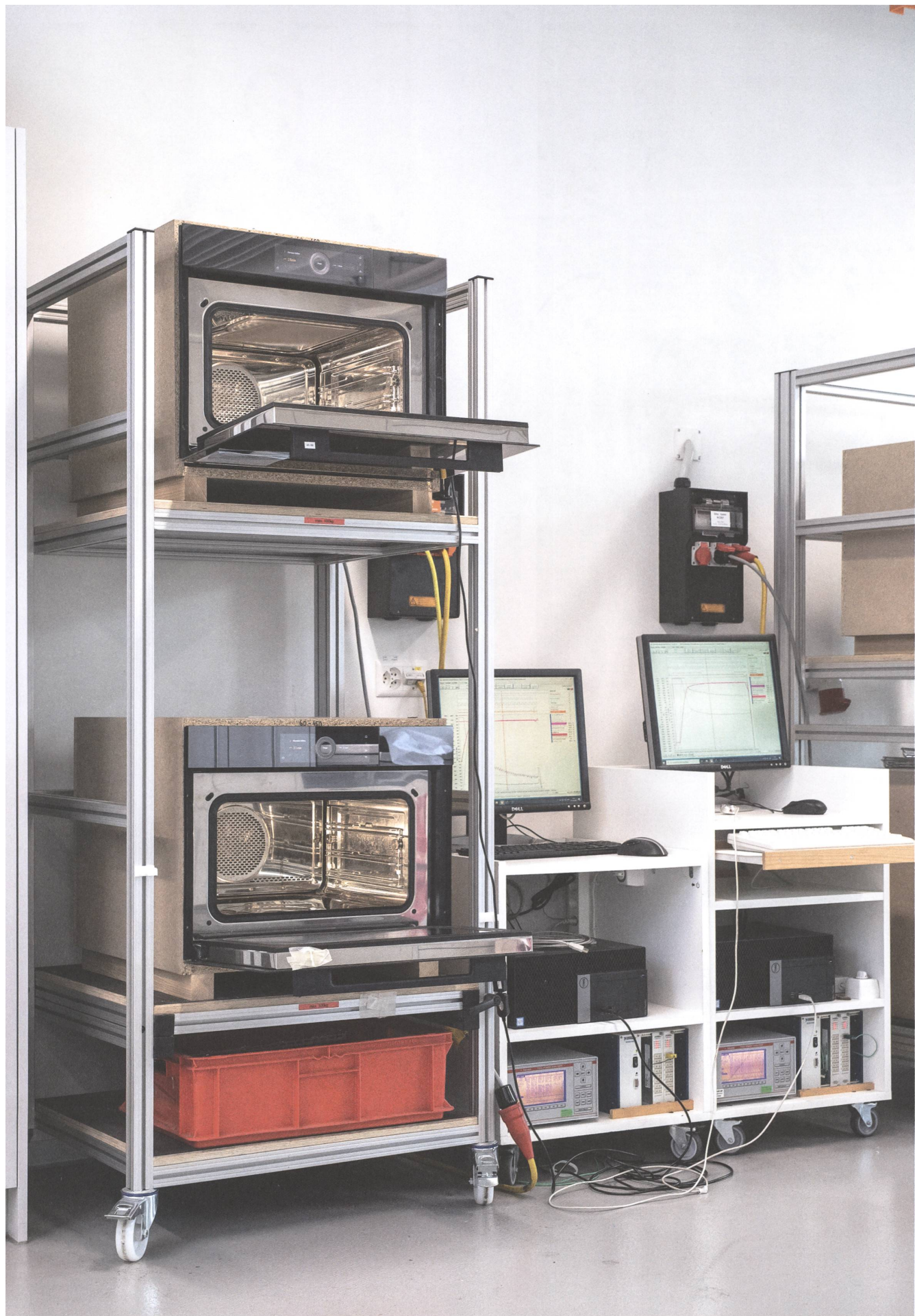
Backöfen der nächsten Generation im Dauer-Funktionstest.
