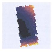
2. Schritt: Das hexagonale Gitter Die Messpunkte werden in ein hexagonales Gitter übertragen - sechseckig lassen sich organische Formen besser darstellen als viereckig. Jedem Hexagon ist der entsprechende Messwert zugewiesen. Im konkreten Fall, wie viel Strasse von diesem Punkt aus sichtbar ist. Die Auflösung, also die Anzahl Hexagone, kann angepasst werden. Das spart Rechenkapazität.
