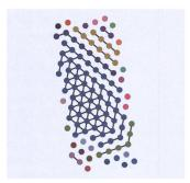
3. Schritt: Das Netzwerkdiagramm Aus der (Heatmap) wird ein Netzwerkdiagramm. Es zeigt das gleiche hexagonale Gitter, aber nur Punkte mit ähnlichen Messwerten sind miteinander verbunden. So ergeben sich Zonen mit gleichen Eigenschaften. Sie sind unterschiedlich eingefärbt und dadurch besser erkennbar. Gebiete mit weniger als drei Knotenpunkten werden weggelassen.
