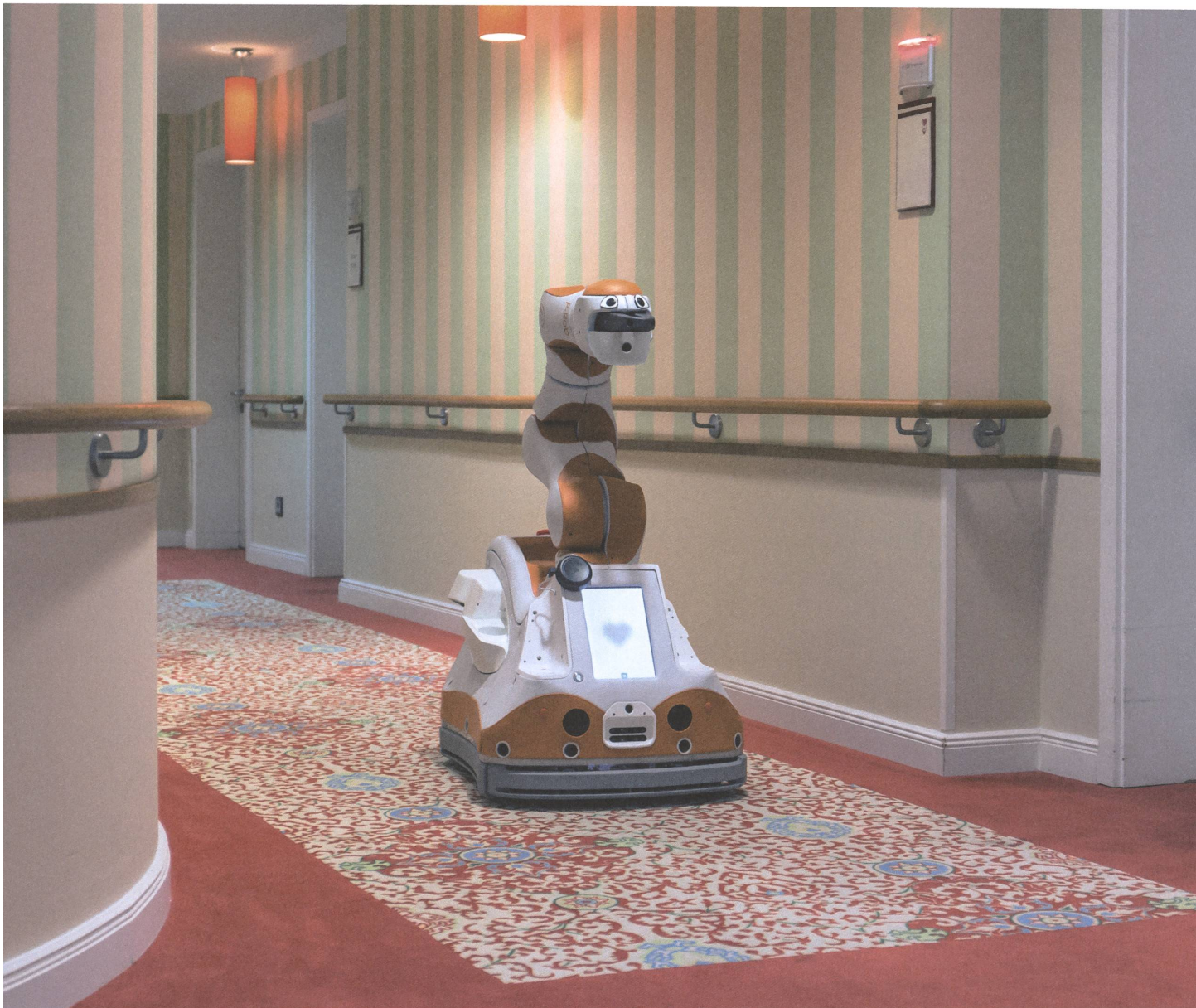
Assistenz- und Pflegeroboter Lio bewegt sich autonom durch die Gänge von Alters- und Pflegeheimen und schaut uns mit den aufgeklebten Augen freundlich an.
