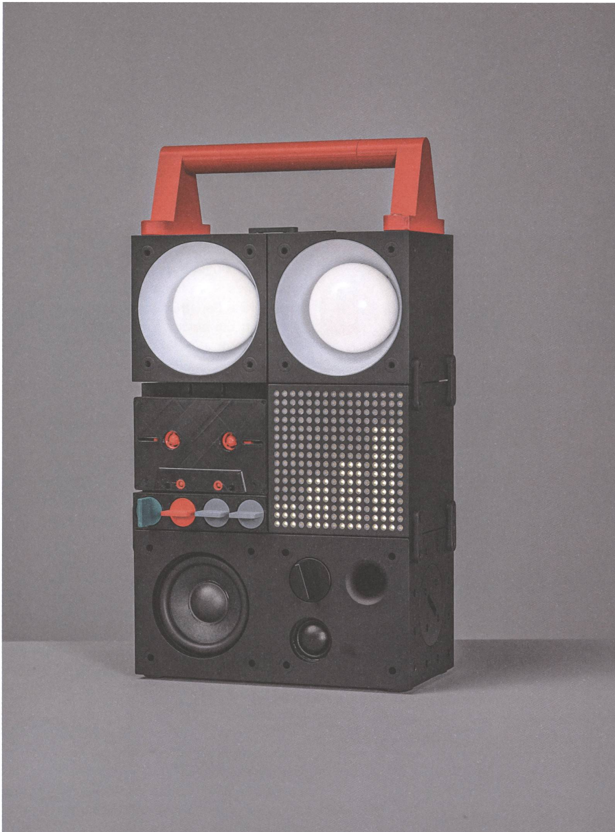
Teenage Engineering entwickelten ein modulares Soundsystem und bieten Files zum Download an, mit denen man zusätzliche Teile wie Griffe oder Räder mit einem 3-D-Drucker selbst fabriziert und an die Boxen schraubt.
