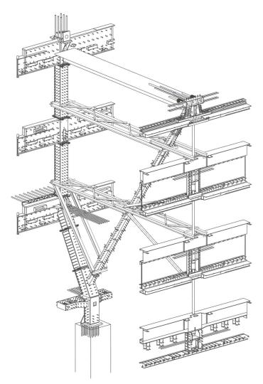
Für die grossen Auskragungen der Decken braucht es eine (Krankonstruktion). Ihr Stahltragwerk ist hier ohne Betonummantelung dargestellt. Grau gezeichnet ist die Hilfskonstruktion vor der Deckenmontage.
