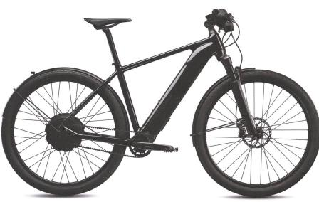
Sportlich unterwegs auf der Langstrecke: Der Antrieb des Elektrobikes (Code) verbirgt sich im Hinterrad, der Akku liegt im Unterrohr versteckt.
