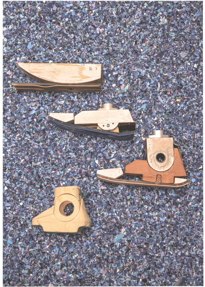
ie Prothese (Circleg) endet in einem Fuss mit gefederter Sohle, die Energie aufnimmt und in die Rückbewegung einspeist. Bis zur Serienreife braucht es viele Prototypen.
