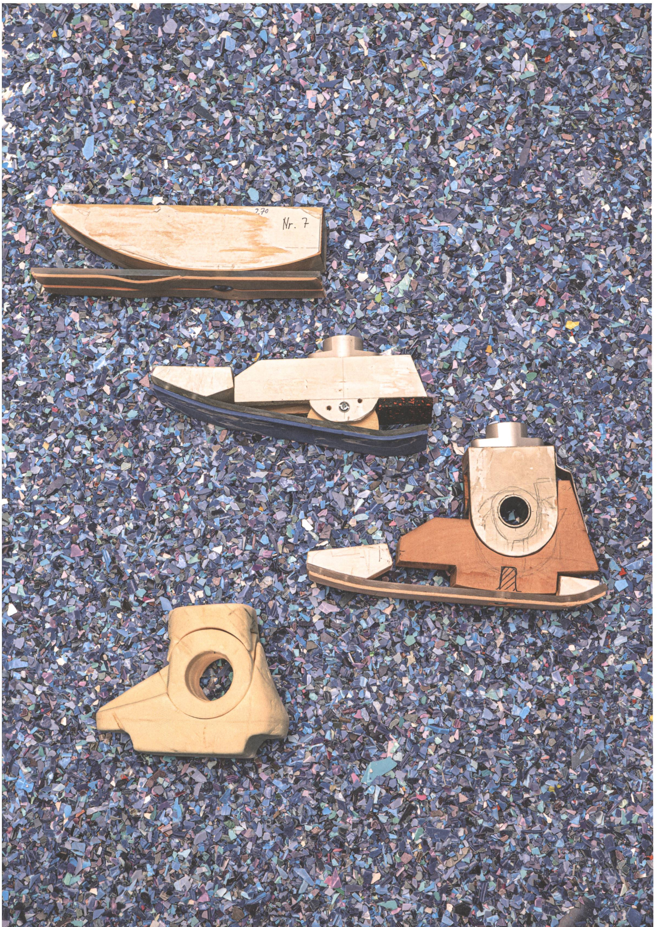
Die Prothese «Circleg» endet in einem Fuss mit gefederter Sohle, die Energie aufnimmt und in die Rückbewegung einspeist. Bis zur Serienreife braucht es viele Prototypen.
