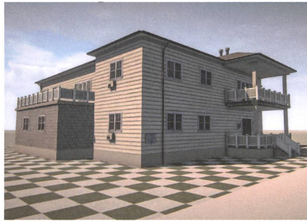
Je weiter weg das Gebäude, desto ungenauer wird es dargestellt: Hier sind es 8700 Dreiecke, ...
