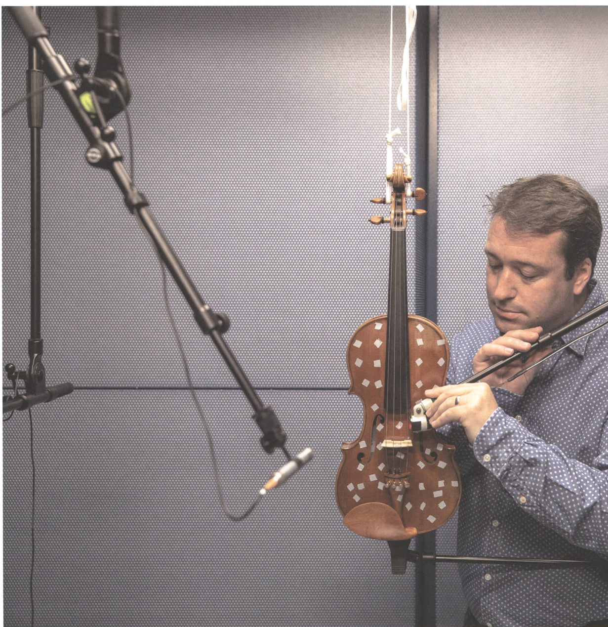
Der Akustikforscher Armin Zemp testet im schalltoten Labor der Empa Geigen aus Holz, das mit einem Pilz behandelt worden ist.
