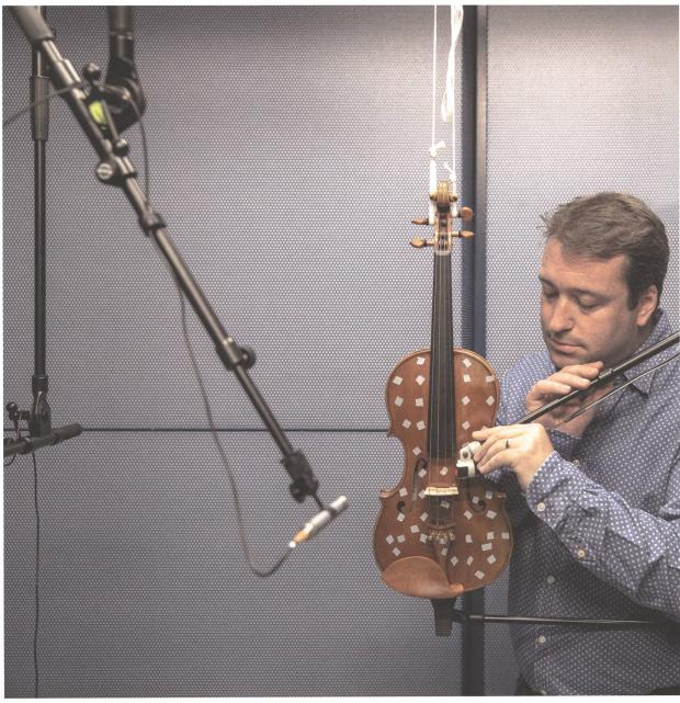
Der Akustikforscher Armin Zemp testet im schalitoten Labor der Empa Geigen aus Holz, das mit einem Pilz behandelt worden ist.
