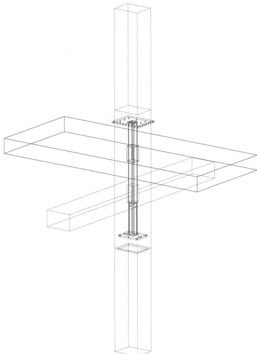
Ein Stahlteil überträgt die Kräfte von einer Holzstütze zur nächsten. |
