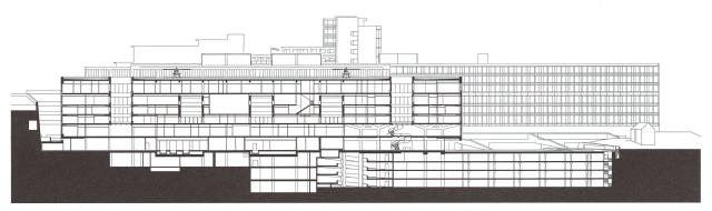
11 Längsschnitt durch Lichthöfe (links und rechts), innere Hallen (Mitte) und Untergeschosse mit Technik und Tiefgarage.
