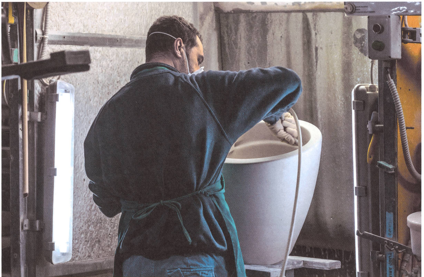
Die Rohkeramiken werden nachbearbeitet, vorgetrocknet und danach mit Glasur besprüht, bis sie für den Brennprozess bereit sind.
