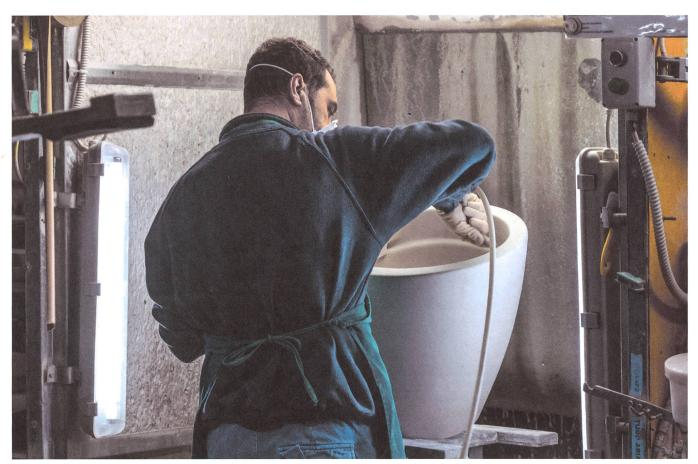
Die Rohkeramiken werden nachbearbeitet, vorgetrocknet und danach mit Glasur besprüht, bis sie für den Brennprozess bereit sind.
