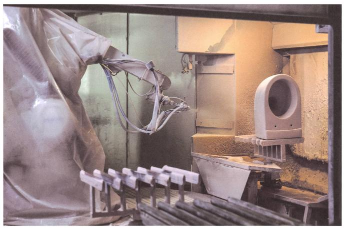
Die Glasur wird maschinell aufgetragen.
