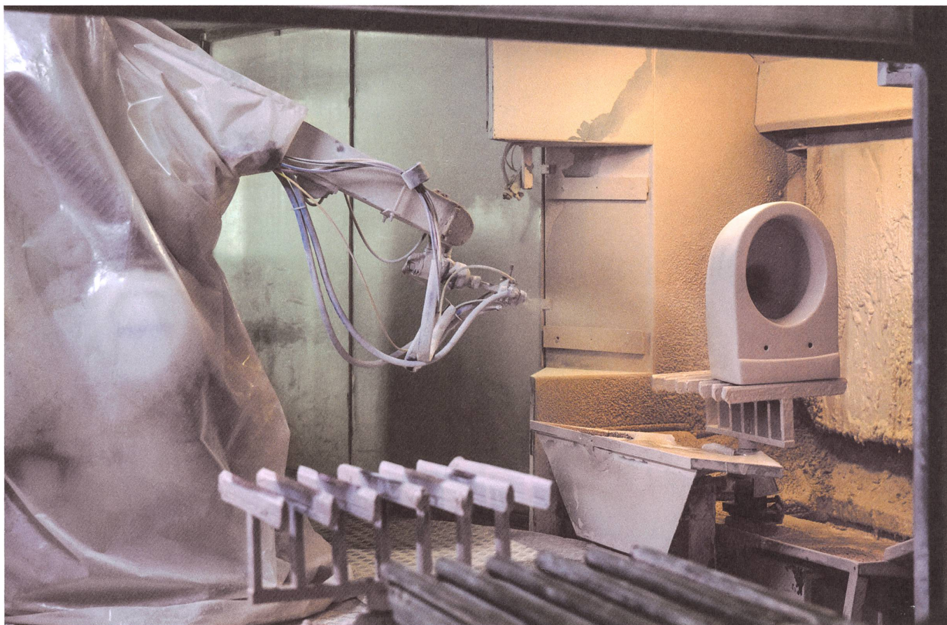
Die Glasur wird maschinell aufgetragen.
