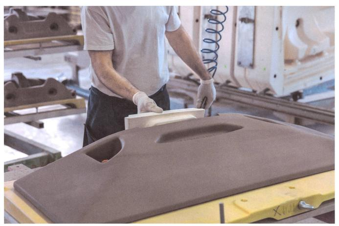
$\label{thm:continuous} \textbf{Der Waschtisch} \\ \textbf{Geberit ONE)} \\ \textbf{wird vor und nach dem Brennvorgang sorgfältig auf seine Massgenauigkeit geprüft.} \\$
