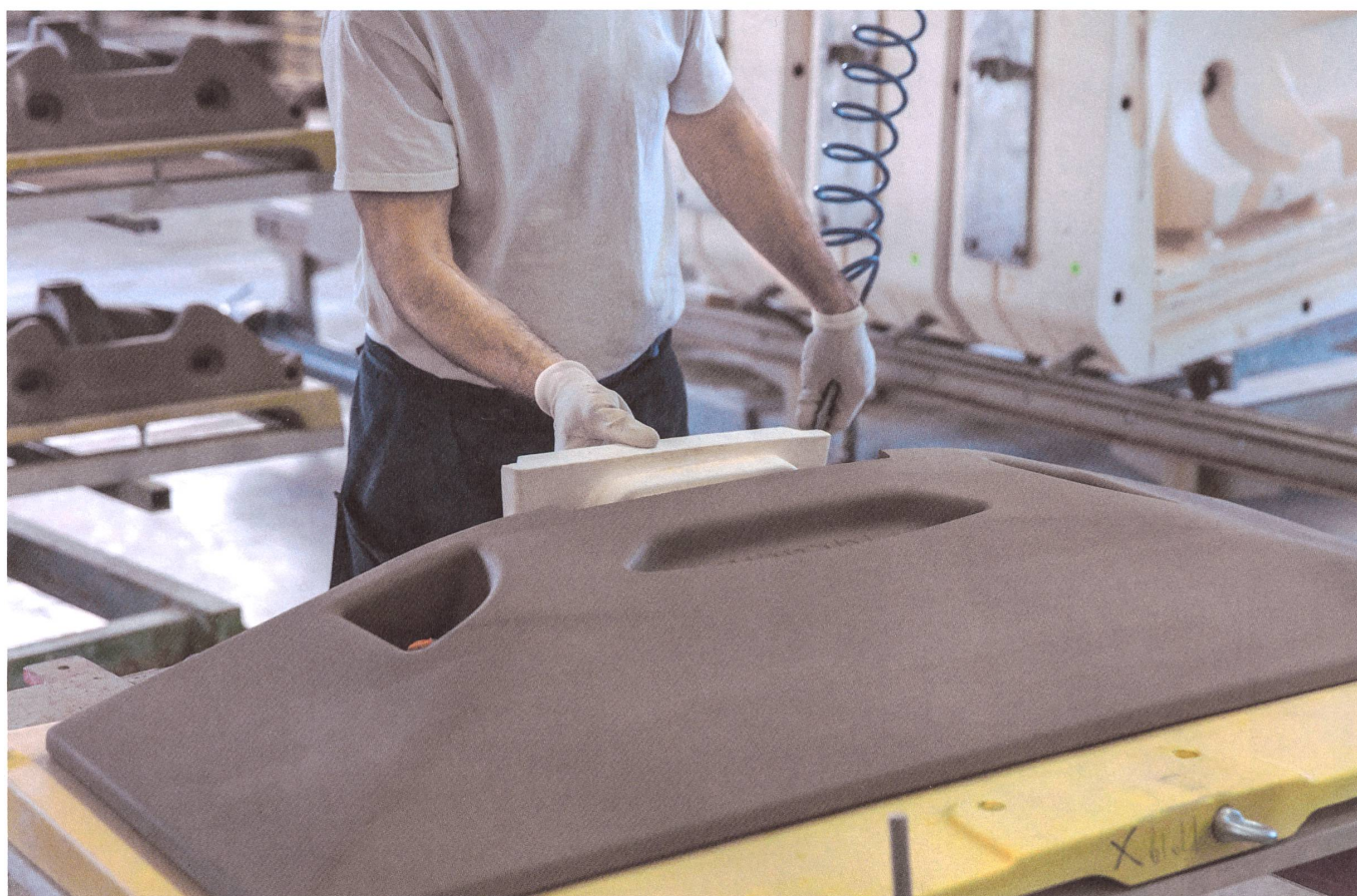
Der Waschtisch «Geberit ONE» wird vor und nach dem Brennvorgang sorgfältig auf seine Massgenauigkeit geprüft.
