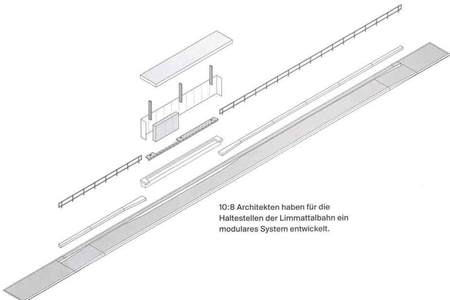
10:8 Architekten haben für die Haltestellen der Limmattalbahn ein modulares System entwickelt.
