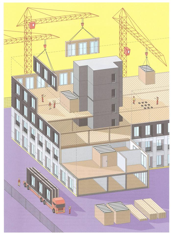
Hausbau just-in-time (Lean Construction): Wände, Decken und Bäder erreichten die Baustelle immer gerade rechtzeitig zur Montage.
