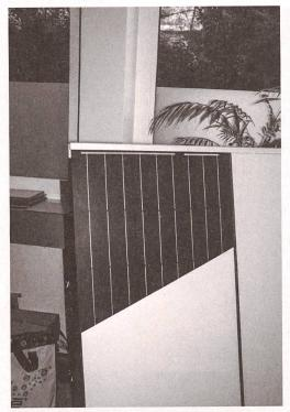
Ein Blick hinter die Nanotechnologie-Haut des weissen Solarmoduls, entwickelt am CSEM.
