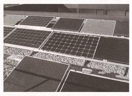
Auf dem Dach werden verschiedene PV-Module getestet.
