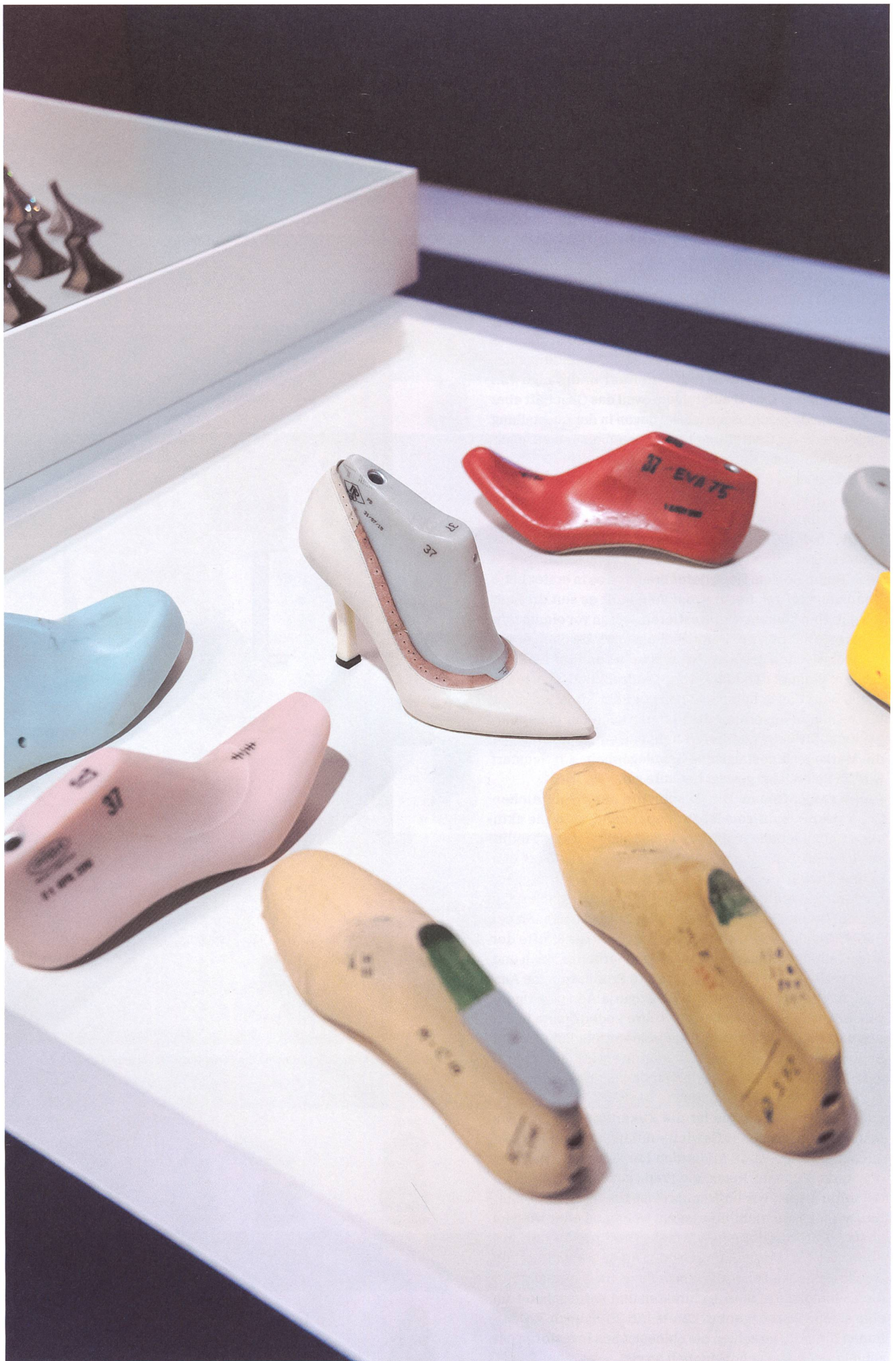
Die Leisten simulieren in der Herstellung den menschlichen Fuss.
