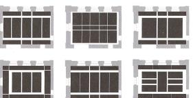
Für die Werkräume entwarf das Büro Neuhaus verschiedene akustisch vorteilhafte Deckengeometrien.
