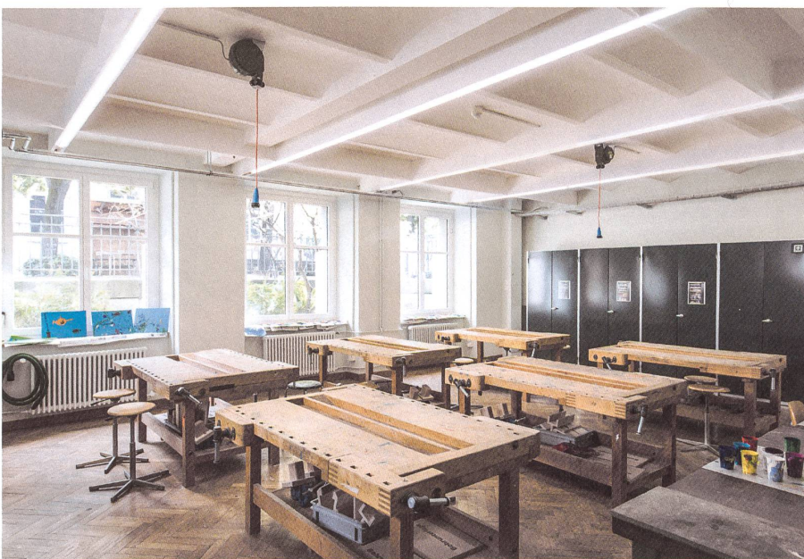
Sprechen und Zuhören erleichtert: Die Rippen an Wand und Decke sowie die Ablage aus Eichenholz an der Längswand sind nicht nur raum-, sondern auch klangbildend.
