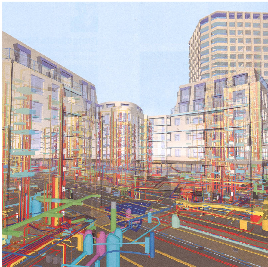
Im Bild des BIM-Modells des Glasi-Quartiers ist das Terrain ausgeblendet und die Hauswände sind zum Teil transparent. Zum Vorschein kommen die Werk- und Haustechnikleitungen, die je nach Funktion anders eingefärbt sind.
