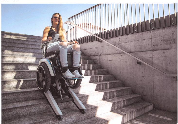
Mit Raupen angetrieben ist der auf einer Achse balancierende Rollstuhl (Scewo Bro) auch auf Treppen, rutschigen oder unebenen Untergründen sicher unterwegs.
