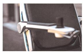
Gesteuert wird über einen Joystick, der in die höhenverstellbare Armlehne integriert ist.
