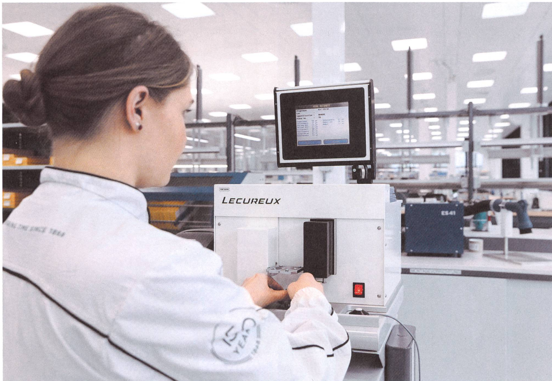
Eine IWC-Mitarbeiterin an einer Höhenspiel-Messstation der Bieler Ingenieure. Damien Regamey überarbeitet sie, um sie etwa für Links- wie Rechtshänder bedienbar zu machen.
