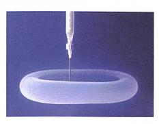
Beim (Rapid Liquid Printing) zieht eine Düse Linien durch ein Gel.
