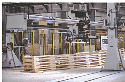
20 Ein Roboter montierte die 48 624 Latten zu Trägern zusammen.
