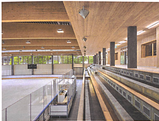
26 Das Holzdach sitzt auf Betonstützen.
