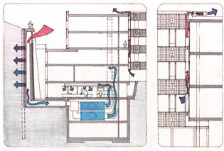
Die Erdregister-Fassadenaktivierung am ETH-Forschungsgebäude. Skizze: Boltshauser Architekten
