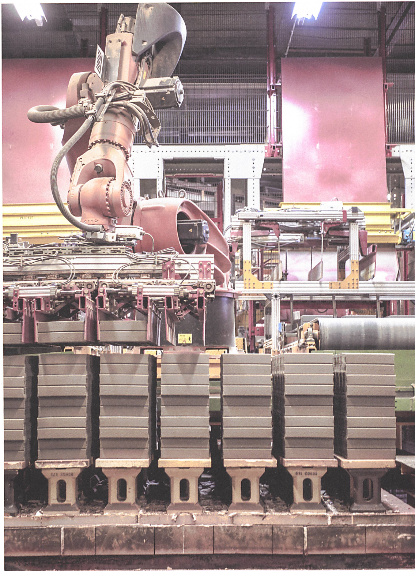
In der Backsteinproduktion bestapelt der Industrieroboter die Ofenwagen mit je nach Stein und Brennweise unterschiedlichem Setschema, später entlädt er sie auf Paletten.
