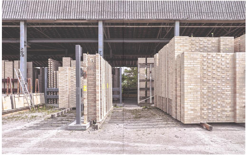
/orgefertigte Wandelemente wiegen meist maximal sieben Tonnen, denn hier ist die Komfortgrenze des Hallenkrans und der meisten Baustellenkräne erreicht
