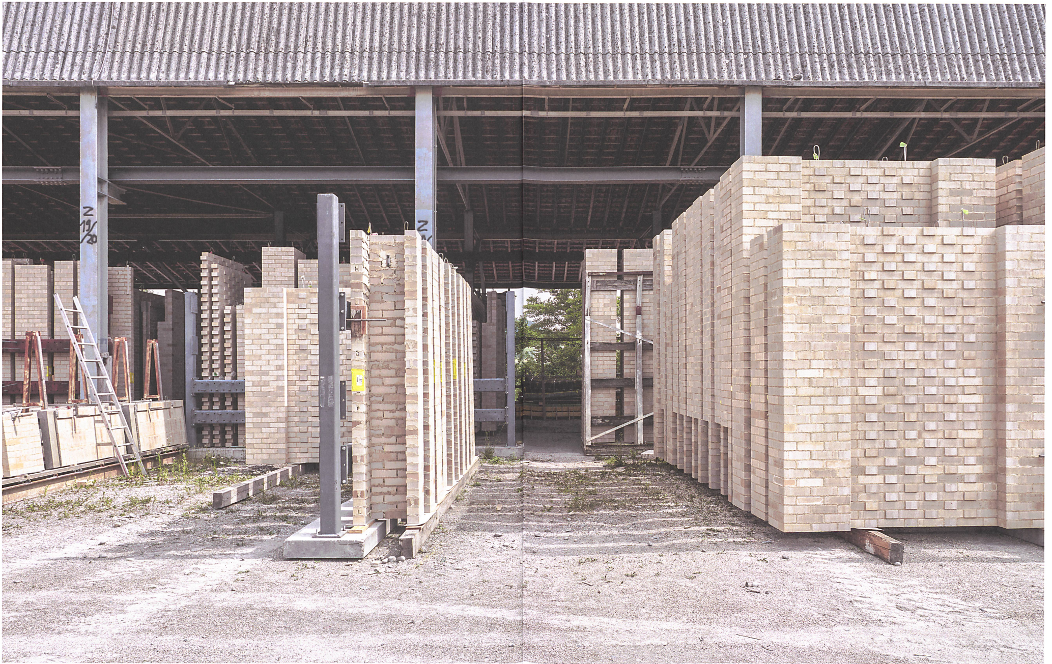
Vorgefertigte Wandelemente wiegen meist maximal sieben Tonnen, denn hier ist die Komfortgrenze des Hallenkrans und der meisten Baustellenkräne erreicht.
