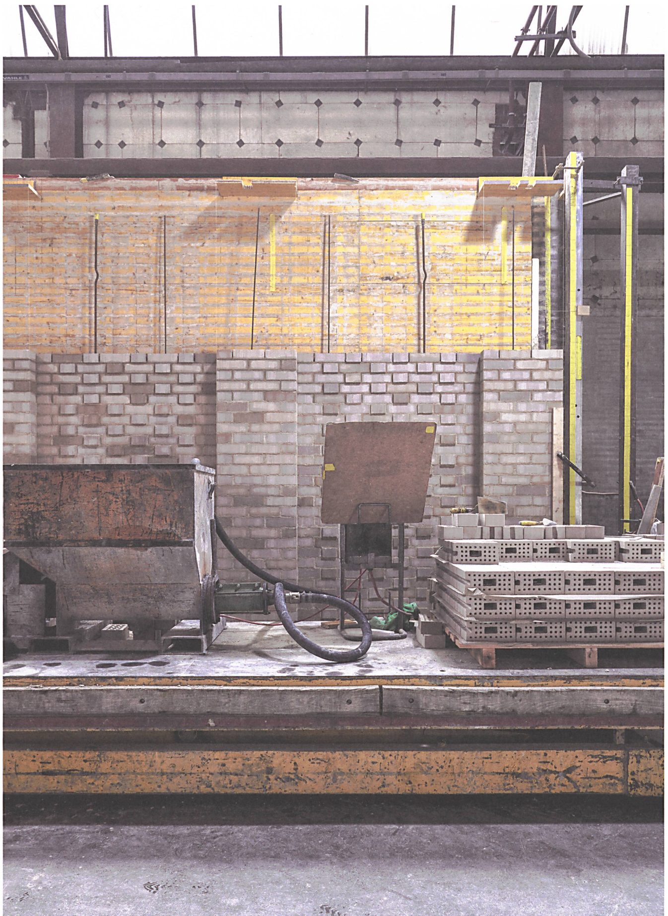
An einer schrägen Wand fädeln Maurer die gelochten Steine mit Nut an zwei Transportankern ein. Lageweise tragen sie Pumpmörtel auf und pressen ihn in die Stossfugen.
