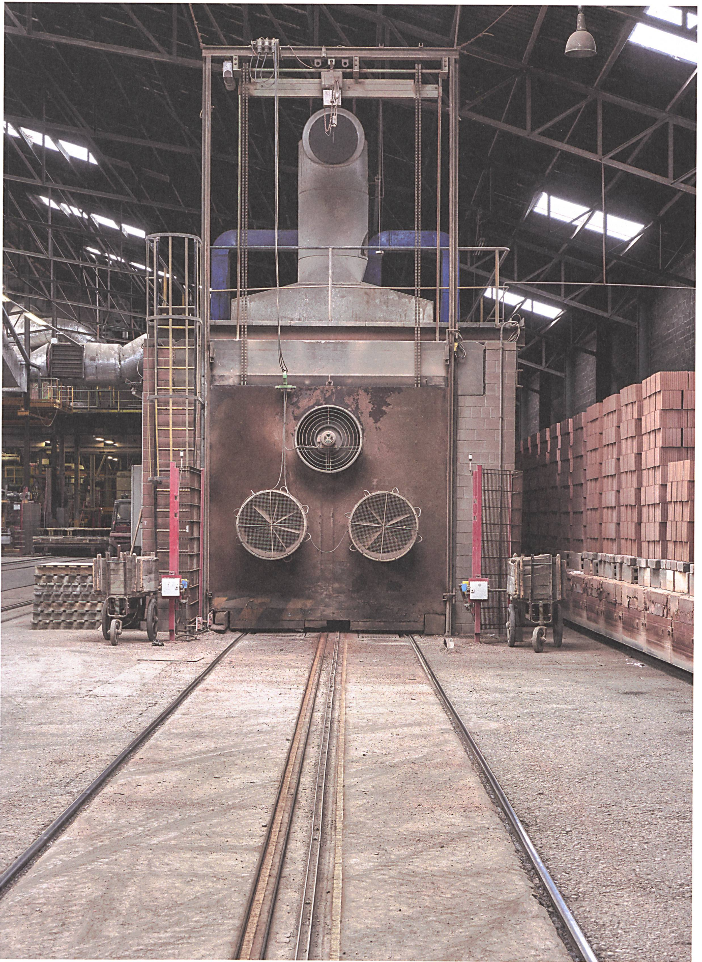
Brennen: Im 130 Meter langen Tunnelofen werden die trockenen Rohlinge nach einem austarierten Temperaturprofil aufgeheizt, gebrannt und wieder abgekühlt.
