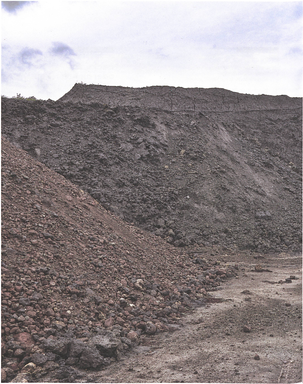
Im Lehmdepot lagern verschiedene Sorten: fettig oder mager, hell oder dunkel, grob oder fein.
