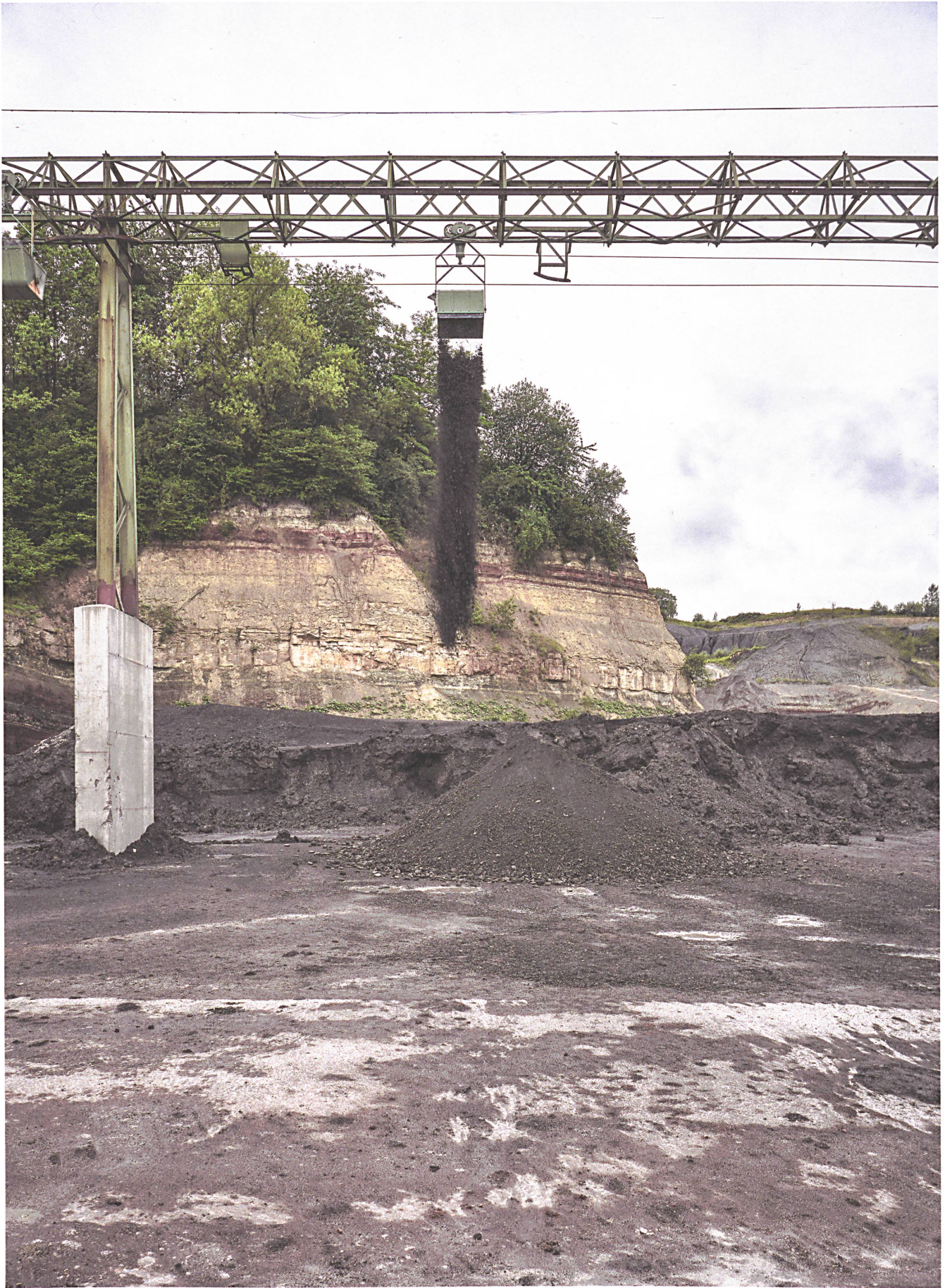
Wagen für Wagen transportiert eine Kuppelbahn aus den Dreissigerjahren Lehm von der Grube zum 1,2 Kilometer entfernten Werk im aargauischen Frick.
