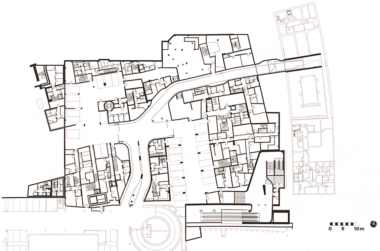
Das Untergeschoss der neuen Altstadt basiert auf der Tiefgarage des abgerissenen Technischen Rathauses und schliesst auch die vorhandenen U-Bahn-Aufgänge ein.
