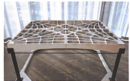
Schalen für alle: Philippe Blocks Team entwickelte Deckenelemente, deren Traggerippe 3-D-gedruckt und zwei Zentimeter dick ausbetoniert wird. Fotos: ETH Zürich, Block Research Group
