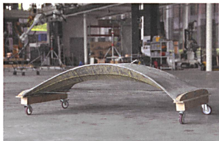
Schalung aus Stoff: Block forscht derzeit an komplexen Geweben, die eine Maschine strickt und die mit Beton bestrichen aushärten.
