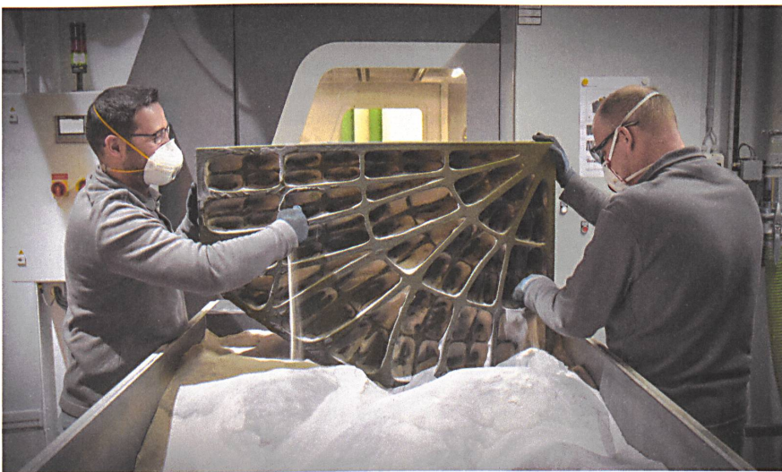
Schalen für alle: Philippe Blocks Team entwickelte Deckenelemente, deren Traggerippe 3-D-gedruckt und zwei Zentimeter dick ausbetoniert wird. Fotos: ETH Zürich, Block Research Group
