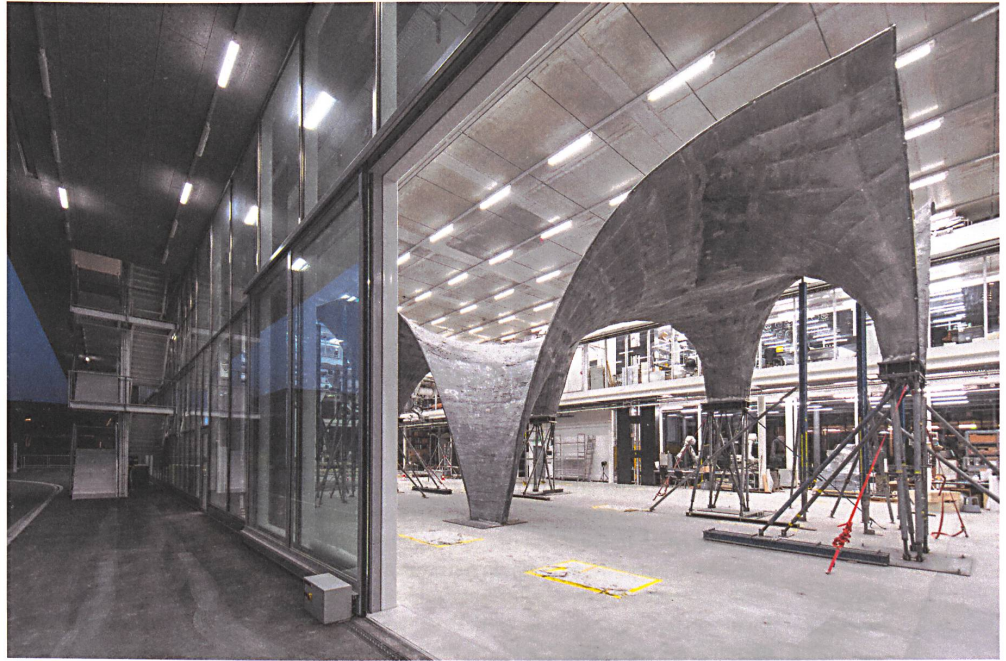
Hängend betonieren: Für das «Nest»-Gebäude der Empa in Dübendorf bauten die Forscher einen Prototyp, für dessen Dach sie ein Stahlseilnetz mit einem Gewebe spannten und als hängende Schalung nutzten. Fotos: Naida Iljazovic, Michael Lyrenmann
