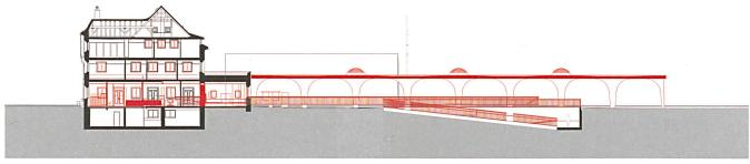
Längsschnitt: Eine lange Bogenhalle nimmt nun die Züge in Zernez auf, eine Unterführung mit Rampe ermöglicht den Zugang für alle.
