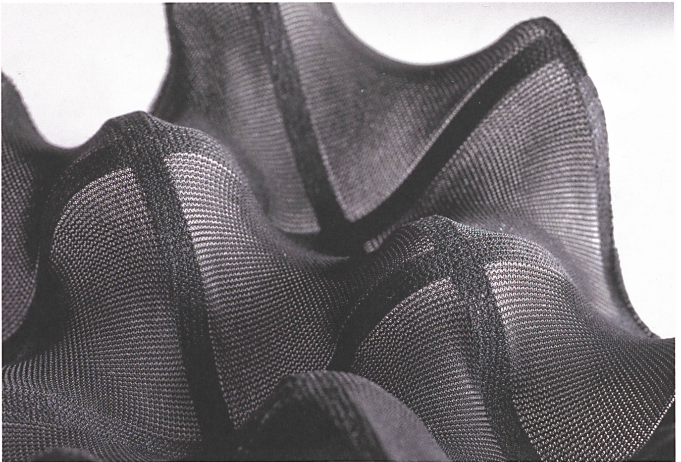
Das Projekt «Active Textiles» untersucht, wie sich gespannt bedruckte Textilien zu Körpern formen, sobald das Textil entspannt wird.
