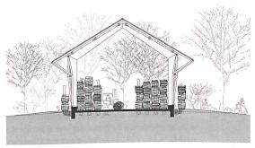
Querschnitt der Lagerhalle für 600 Ster Brennholz.
